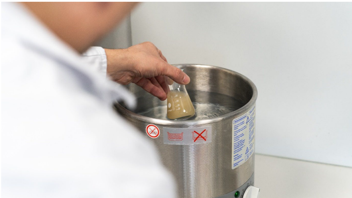
Abr. 1 : Prédispersion de l'échantillon dans le bain ultrasonique
