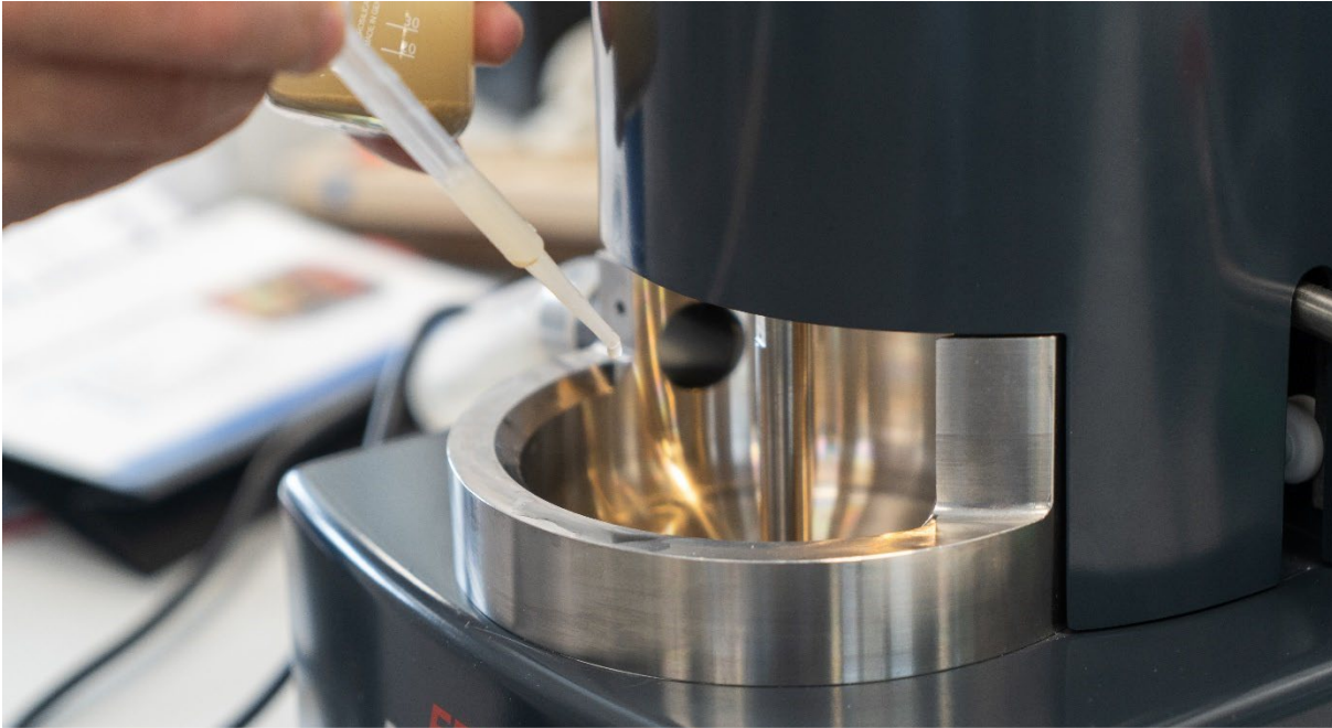
Abr. 2: Pipetage de l'échantillon pré-dispersé dans l'unité de mesure humide de l'A-22 NeXT
